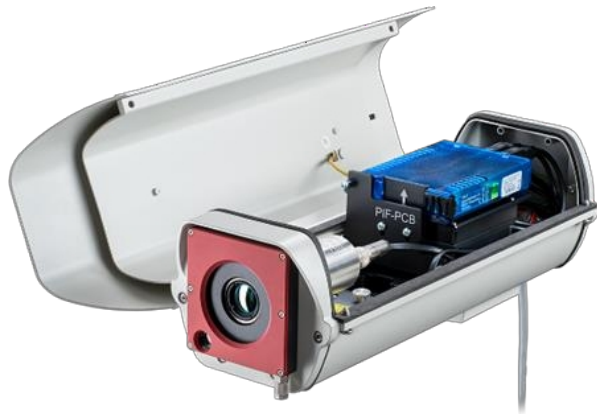
Rysunek 22: Obudowa ochronna do użytku na zewnątrz dla kamery Xi
